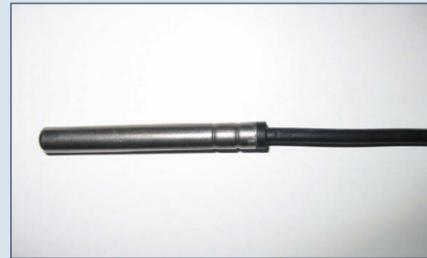
Aufgrund möglicher Toleranzen des optionalen Produkt-Temperaturfühlers kann die angezeigte Produkt-Temperatur von der Produktfühlertemperatur abweichen. Mit Hilfe der neuen Kalibrationsfunktion kann die angezeigte Produkttemperatur mit der Produktfühlertemperatur an bis zu drei Temperaturpunkten abgeglichen werden. Der Korrekturwert zur Kompensation der Differenzen kann in 0,1°C Schritten eingestellt werden.
