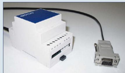
Die RS 485 Busverbindung besteht aus abgeschirmten Datenkabeln, zum Beispiel vom Typ LiYCY 2 x 0,14 mm<sup>2</sup>. Die maximal erreichbare Länge der Datenleitung beträgt 500m, ist jedoch von der Qualität der eingesetzten Komponenten abhängig. Es können maximal 20 Geräte in Serie geschaltet werden.
