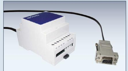
Die RS 485 Busverbindung besteht aus abgeschirmten Datenkabeln, zum Beispiel vom Typ LiCY 2 x 0,14 mm<sup>2</sup>. Die maximal erreichbare Länge der Datenleitung beträgt 500 m, ist jedoch von der Qualität der eingesetzten Komponenten abhängig. Es können maximal 20 Geräte in Serie geschaltet werden.
